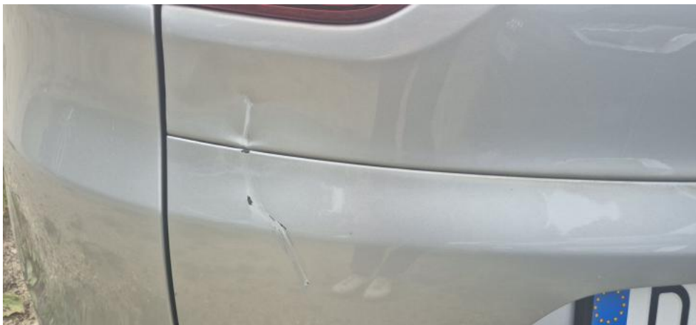
Fot. 61. Pokrywa - zarysowanie 1
