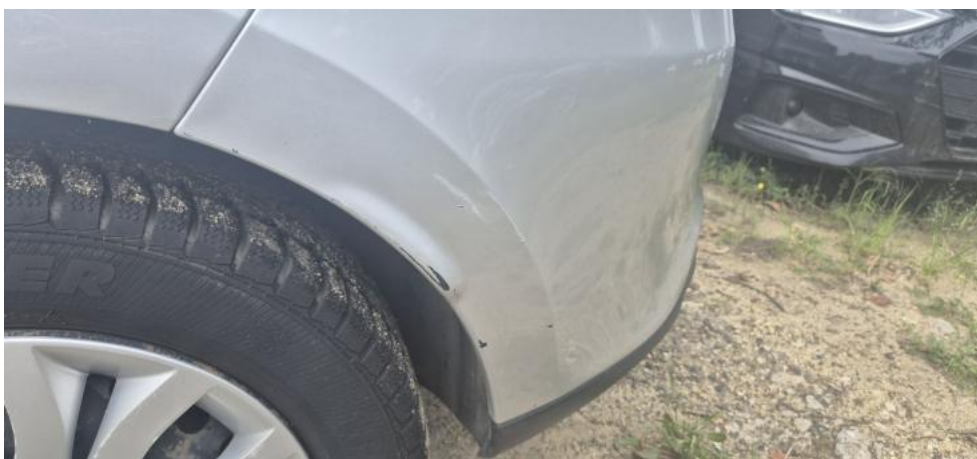
Fot. 62. Zderzak lakier. TYŁ - zarysowanie głębokie o śr. pow. 20 mm 1
