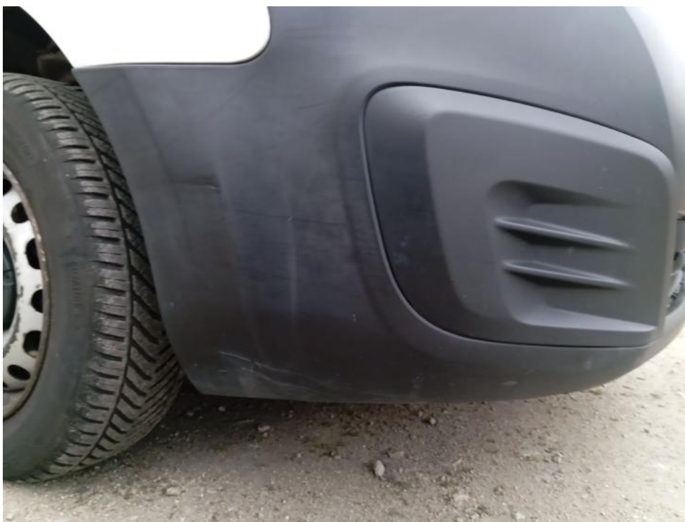
Fot. 72. PRZ - zarysowanie 1
