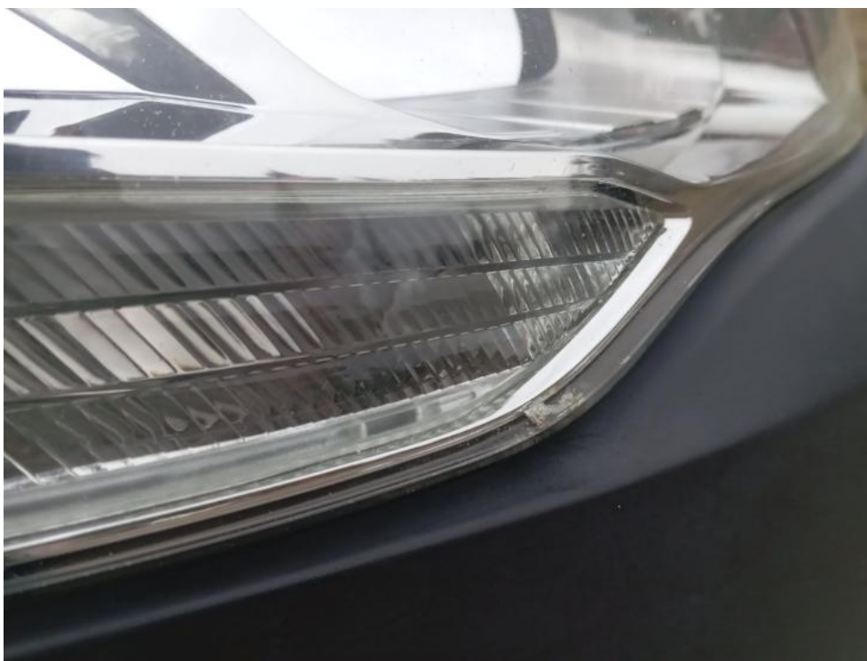
Fot. 35. PP() - nieszczelność 3
