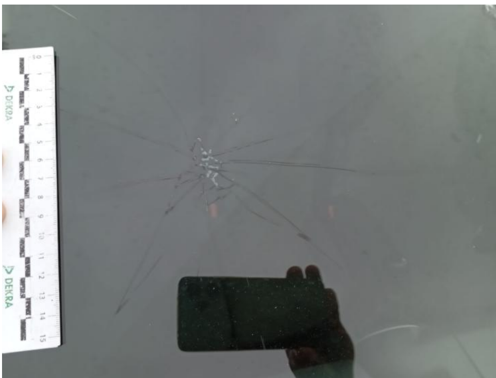
Fot. 63. PRZ() - pęknięcie 3
